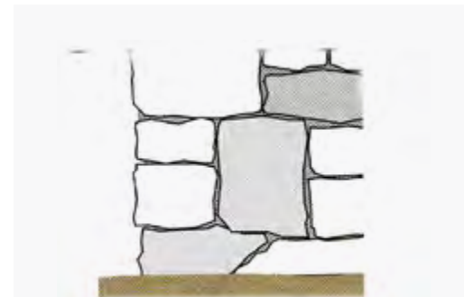
Stena iz grobo obdelanega kamna.
